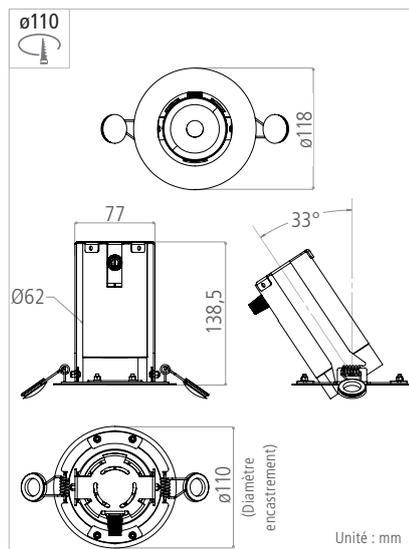
Downlight orientable discret et qualitatif pour la mise en lumière des objets luxueux. La version Trim (avec collerette) permet une intégration dans le plafond suivant le degré de discrétion de l'appareil désiré. L'excellent rendu des couleurs et la large gamme d'optique PMMA 50mm permet la mise en valeur précise et fidèle des produits. Les optiques, la LED et le driver sont interchangeables facilement pour une maintenance simplifiée et une démarche éco-responsable.
